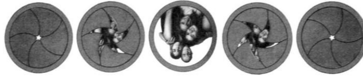
Esquema de funcionamiento del Obturador Central
